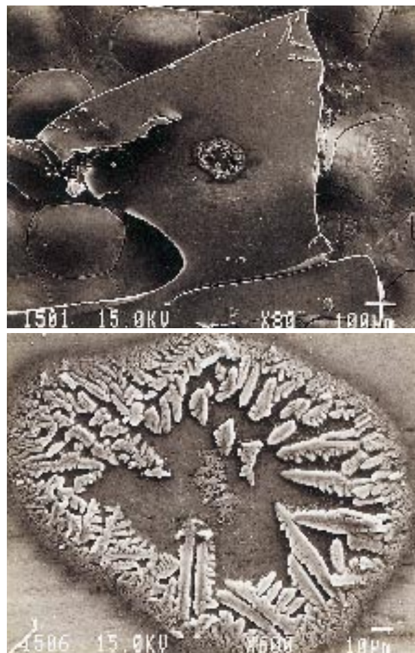
写真6 フクレ内側に付着した汚染物の2次電子像
