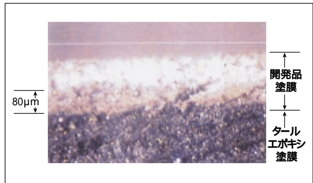
写真2 タールエポキシと開発品界面の塗膜断面
