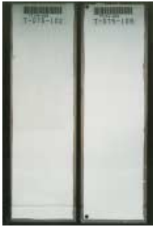
写真1 耐汚染性試験板 右：開発品、左：未処理板 （屋外曝露；東京都大田区にてH11.6～H11.12）
