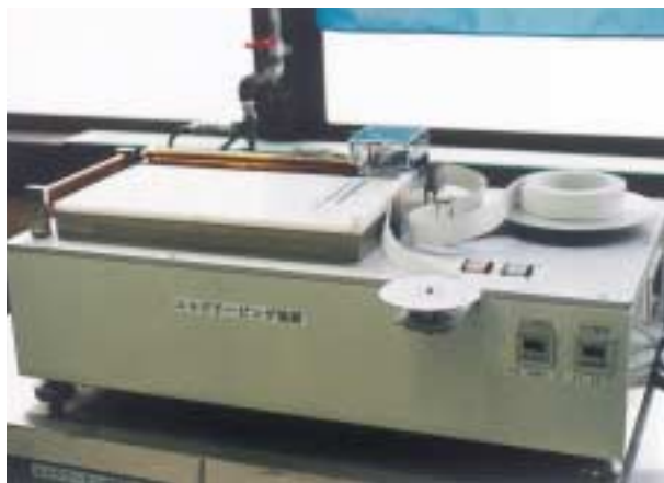
写真2 エッジテーピング装置
