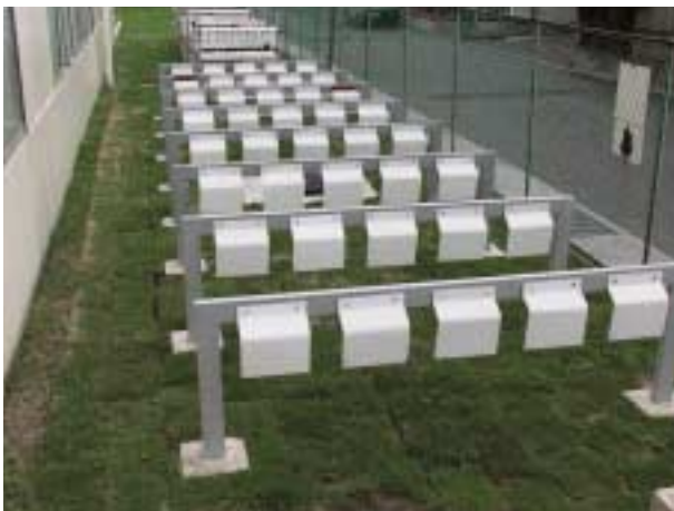
写真1 耐雨筋汚れ性試験の様子
