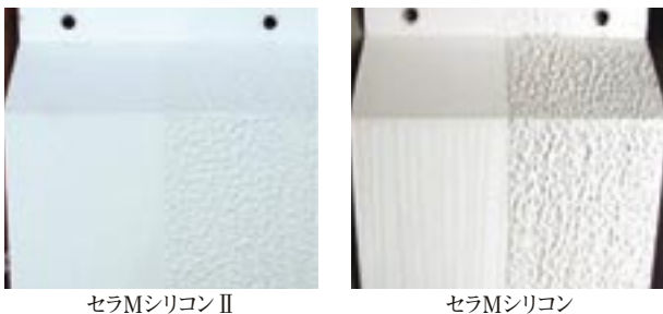
写真1 雨筋汚れ性試験 (尼崎市ばくろ 6ヶ月)
