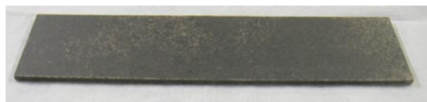
図3 アブラヤシ空果房繊維から作製した繊維板の例
