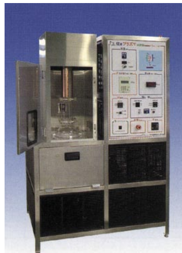
写真10 リモートプラズマ式促進耐候性試験機の外観 37)
