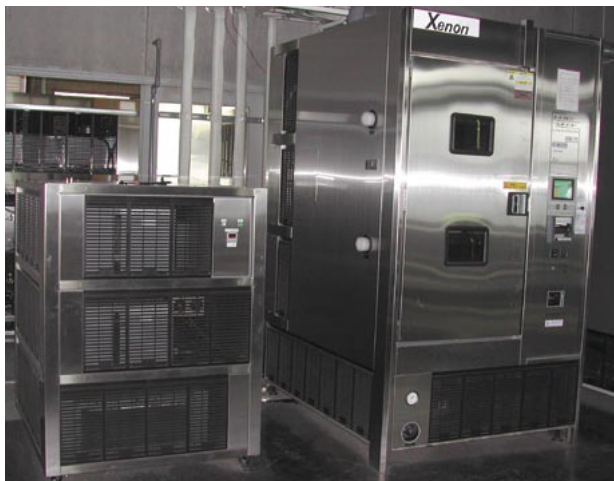
写真7 過酸化水素負荷型促進耐候性試験機の外観 (キセノンアークランプ噴霧式:S社)
