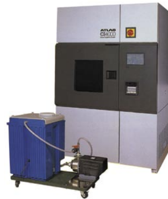
写真6 過酸化水素負荷型促進耐候性試験機の外観 34) (キセノンアークランプ噴霧式:A社)
