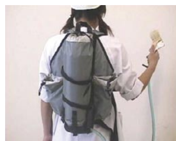
写真13 塗装機装着例
