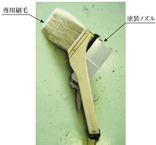
写真10 専用刷毛と塗装ノズル
