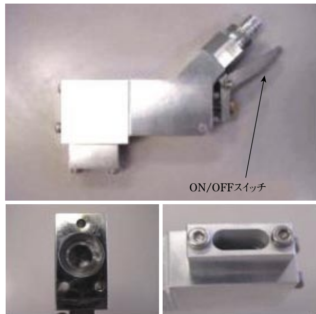
写真6 開発塗装ノズル
