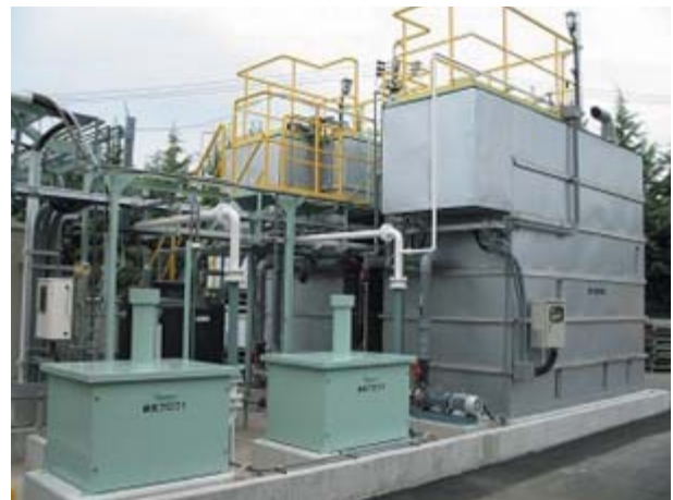
写真1 名古屋事業所排水処理プラントに導入したTDR装置
