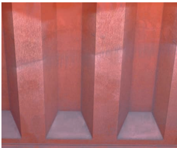
写真4 航行時のゆれにより積荷が沈下した痕跡
