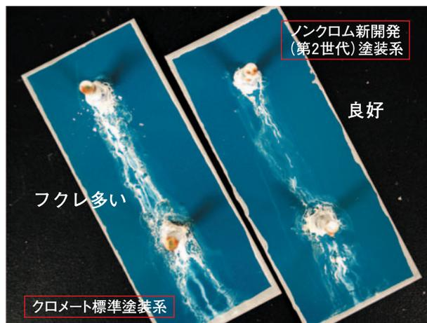
図5 促進耐候性試験後ボルト締めSST168H
