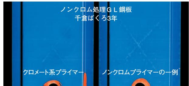
図1 塩害地域ばくろ試験で発生する平面部のフクレ
