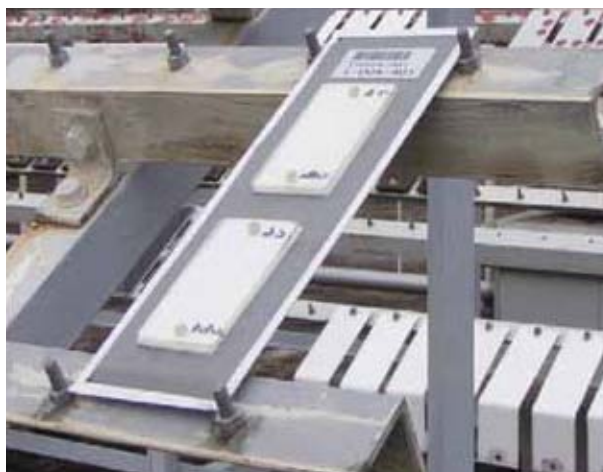
写真2 ポリスチレン板の屋外ばくろ試験
