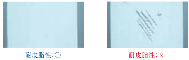
図2 耐皮脂性試験後の塗膜状態
