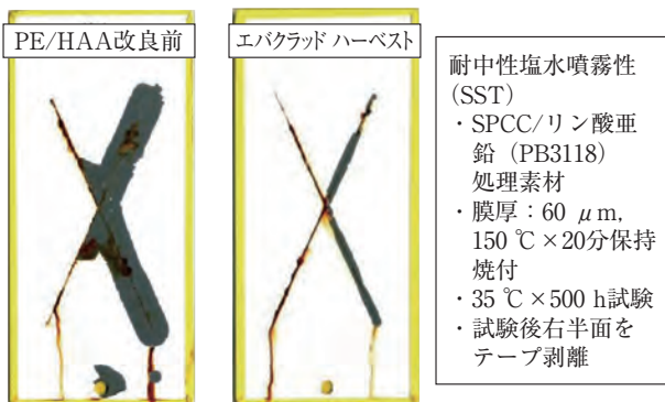
図2 PE/HAA粉体塗料の耐食性試験結果
