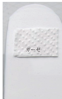
図2 耐皮脂軟化性の試験方法
