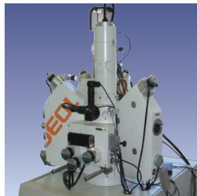
写真3 電子プローブ微小分析 (EPMA) 装置
