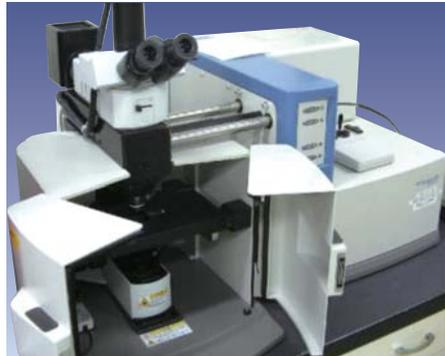
写真2 顕微レーザーラマン分光分析装置
