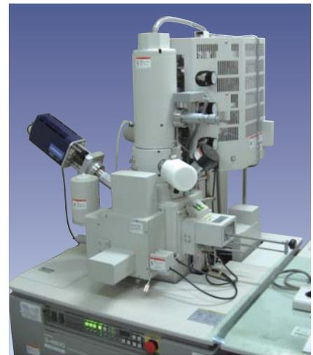
写真1 走査型電子顕微鏡 (日立ハイテック社製 S-4800)
