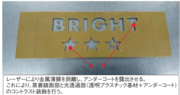
図7 遊技（パチンコ）装飾品のレーザー剥離加工例
