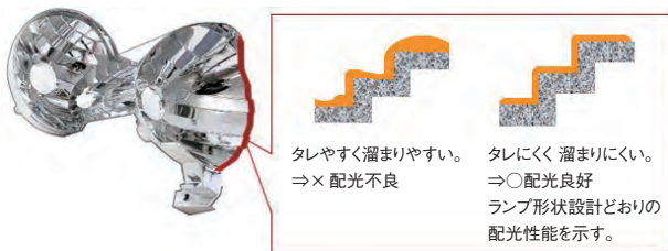
図6 アンダーコートの被覆状態の違いによる配光性の良否
